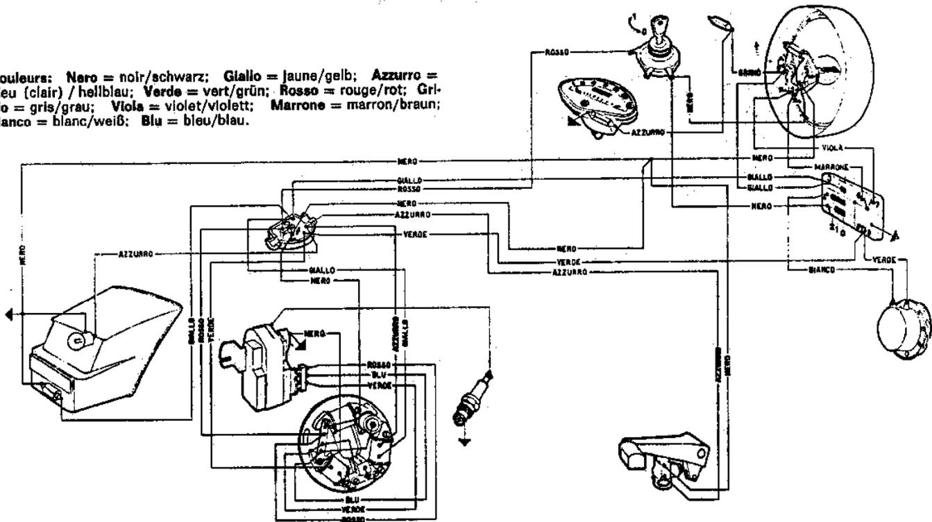
Birnen: 6 V - 25/25 W (Scheinwerfer); 6 V - 5 W (Stadtlicht); 6 V - 5 W (Kennzeichenbeleuchtung); 6 V - 10 W (Bremsleuchte); 6 V - 0,6 W (Scheinwerferkontrolllampe); 6 V - 0,6 W (Tachometerbeleuchtung).
